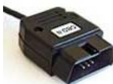
Рисунок 7 – Внешний вид разъема интерфейса CAN
