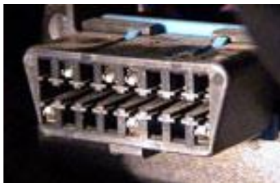
Рисунок 6 – Внешний вид разъема интерфейса OBD-II
